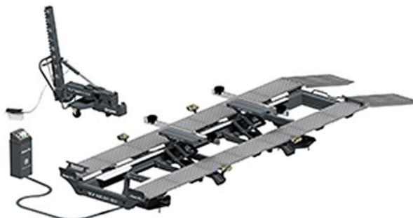
Универсальный стапель для кузовного ремонта с гидравлической системой наклона рамы. Предназначен для высококачественного восстановления геометрии кузовов кроссоверов и коммерческого транспорта, по классической и шаблонной системе. Имеет двойную систему второго подъема.
